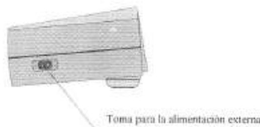
Fig. 4 Toma para la alimentación externa
